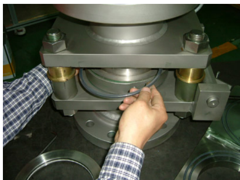
Шаг 5) Замените внутреннее уплотнительное кольцо.
